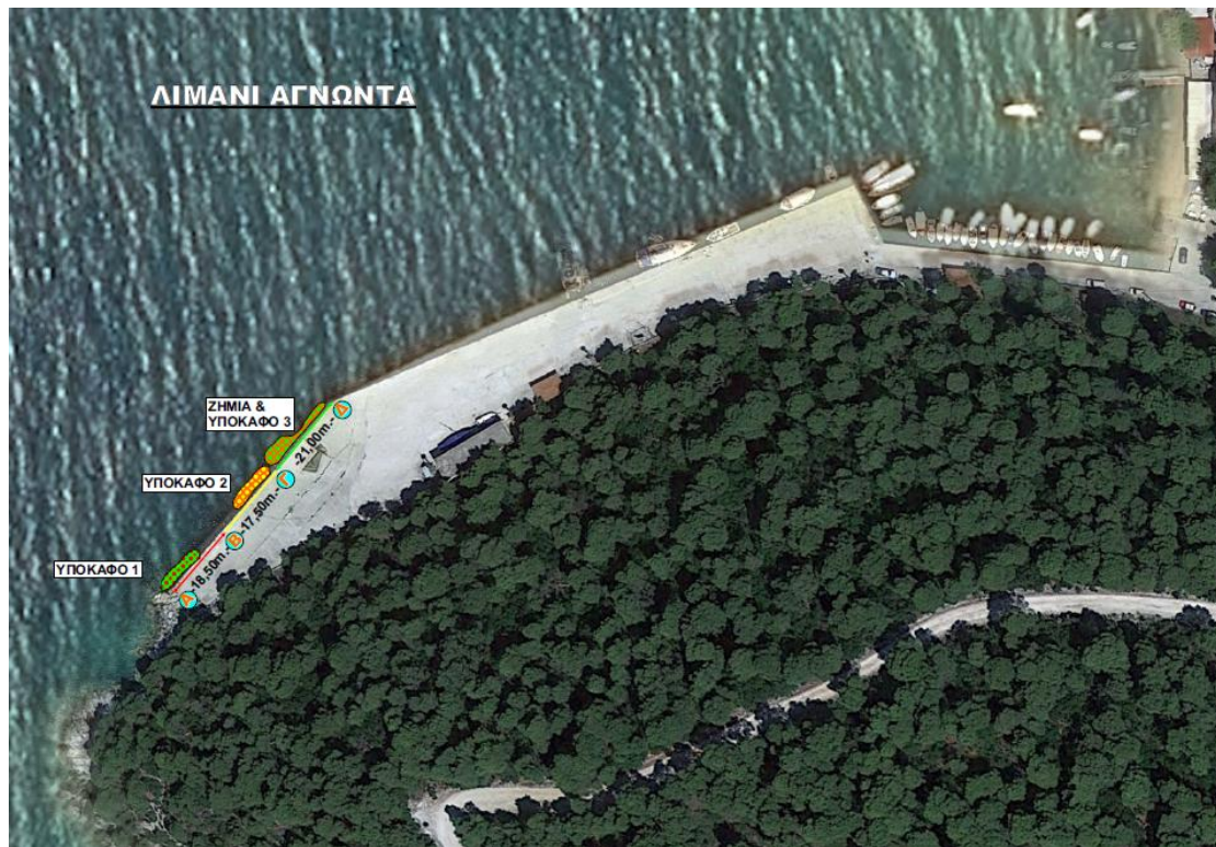
Εικόνα 3-1 Περιοχές υποσκαφών στο τεθλασμένο τμήμα του κρηπιδότοιχου
