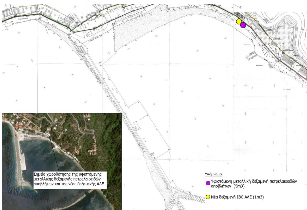
Σχήμα 15: Προτεινόμενη χωροθέτηση υφιστάμενων και νέων δεξαμενών πετρελαιοειδών αποβλήτων και ΑΛΕ στο βόρειο τμήμα του λιμένα Λουτρακίου
