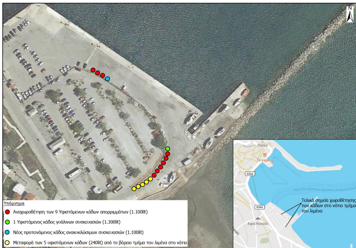
Σχήμα 21: Προτεινόμενη χωροθέτηση υφιστάμενων και νέων κάδων στο νότιο τμήμα του λιμένα Σκοπέλου
