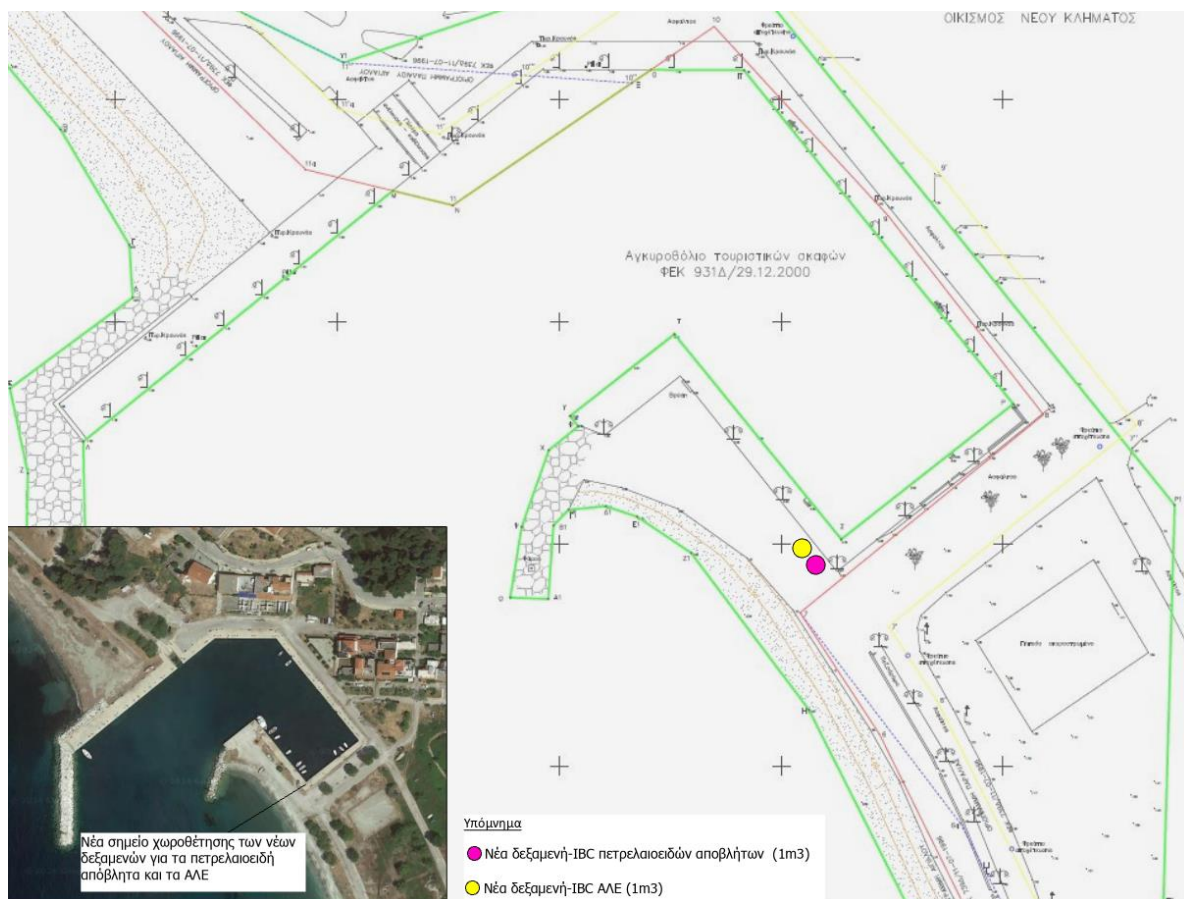
Σχήμα 18: Προτεινόμενη χωροθέτηση των νέων δεξαμενών πετρελαιοειδών αποβλήτων και ΑΛΕ στο ανατολικό τμήμα του καταφυγίου τουρ/κών σκαφών Ν. Κλήματος
