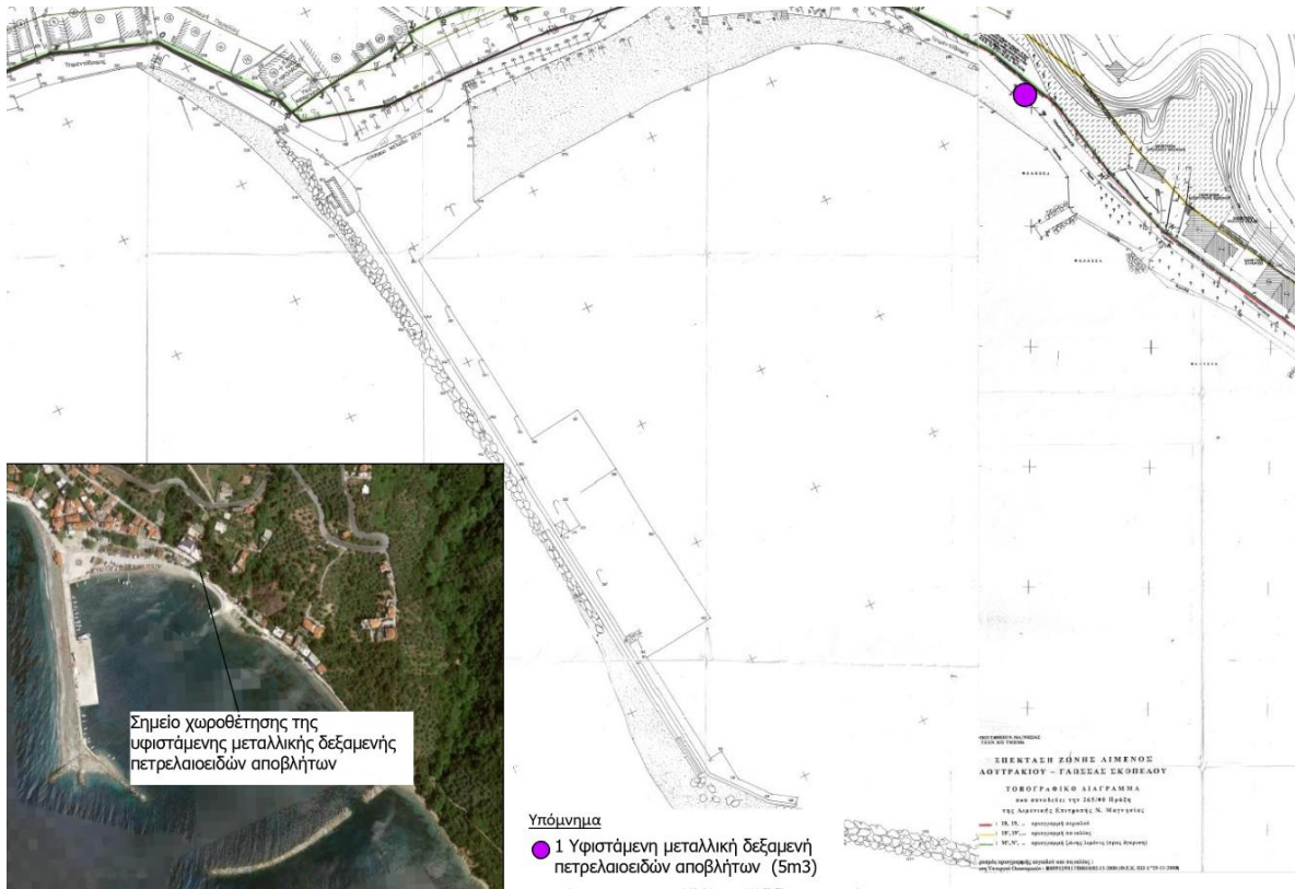
Σχήμα 14: Υφιστάμενη μεταλλική δεξαμενή πετρελαιοειδών αποβλήτων 5m 3 στο βόρειο τμήμα του λιμένα Λουτρακίου
